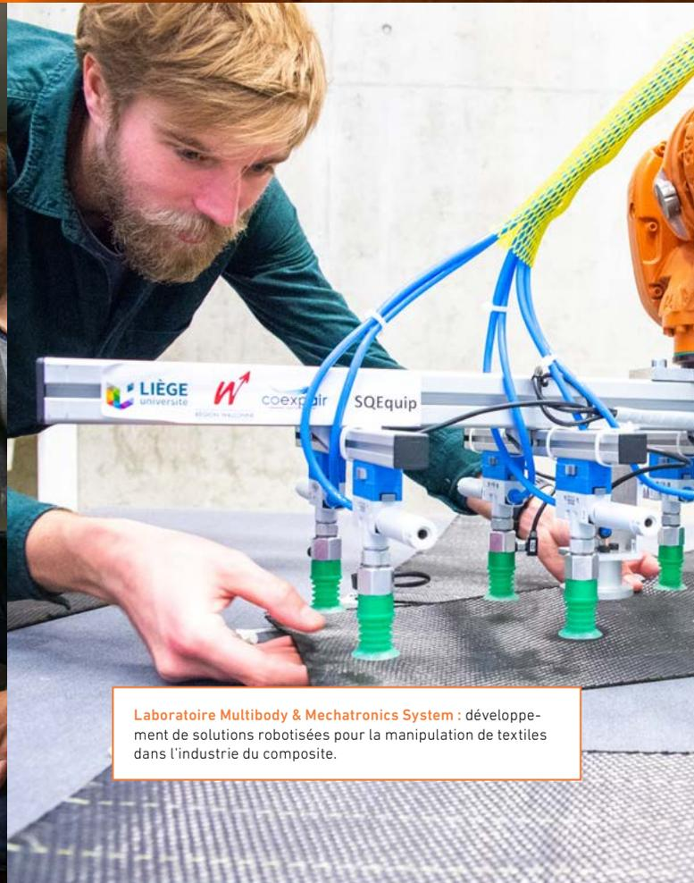
**Laboratoire Multibody & Mechatronics System** : développement de solutions robotisées pour la manipulation de textiles dans l'industrie du composite.
