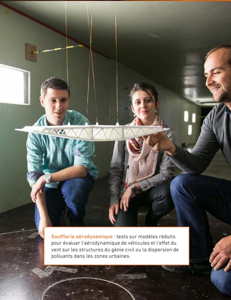
**Soufflerie aérodynamique** : tests sur modèles réduits pour évaluer l'aérodynamique de véhicules et l'effet du vent sur les structures du génie civil ou la dispersion de polluants dans les zones urbaines.
