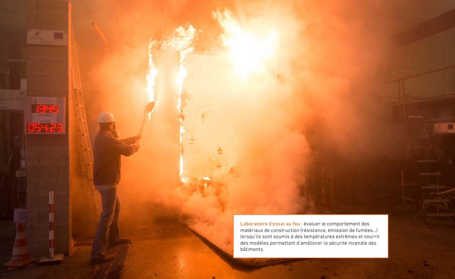
**Laboratoire d'essai au feu** : évaluer le comportement des matériaux de construction (résistance, émission de fumées...) lorsqu'ils sont soumis à des températures extrêmes et nourrir des modèles permettant d'améliorer la sécurité incendie des bâtiments.
