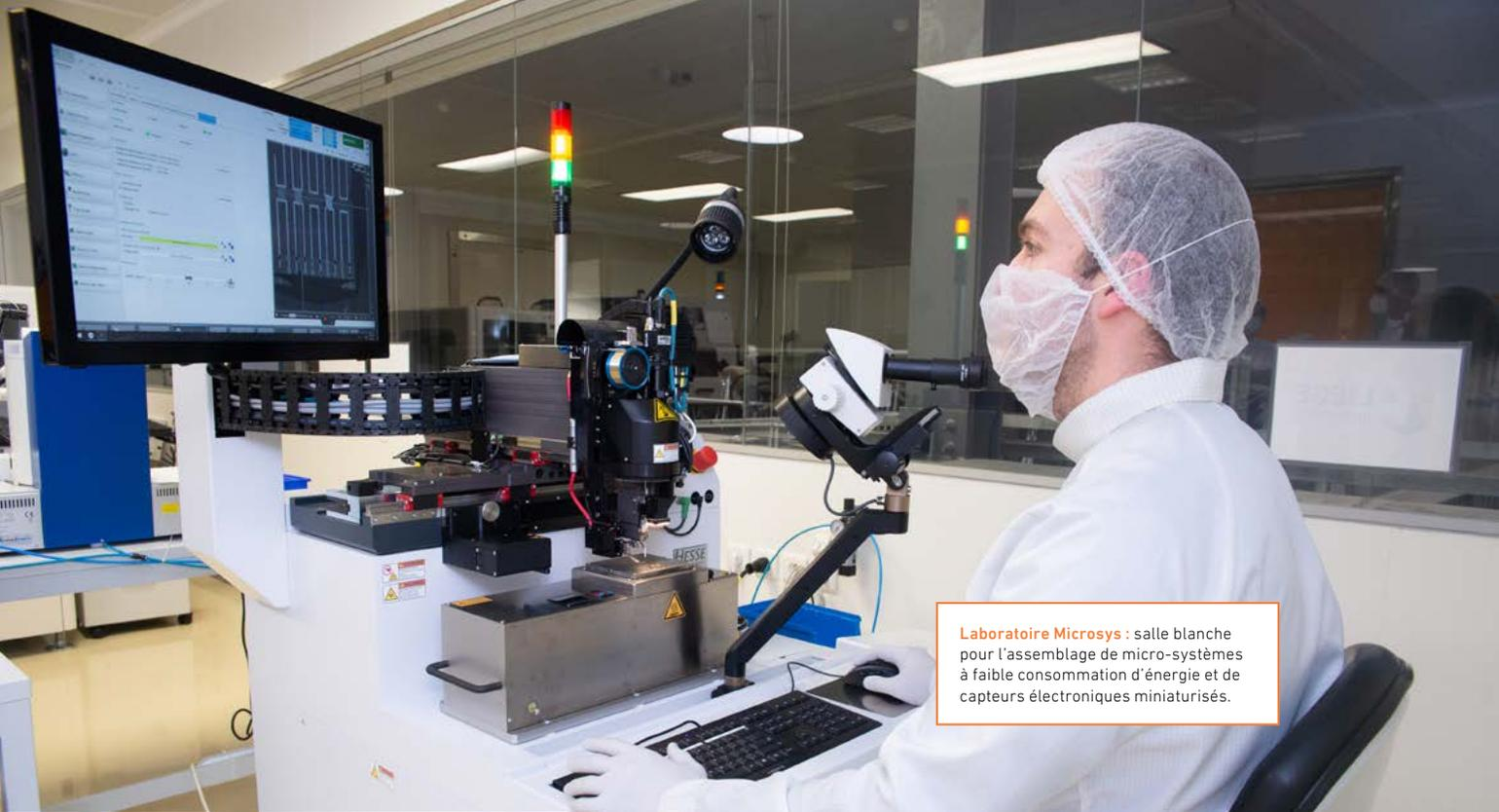
**Laboratoire Microsys** : salle blanche pour l'assemblage de micro-systèmes à faible consommation d'énergie et de capteurs électroniques miniaturisés.
